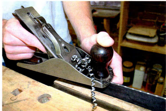
Fig. 19 Planing the edge straight
